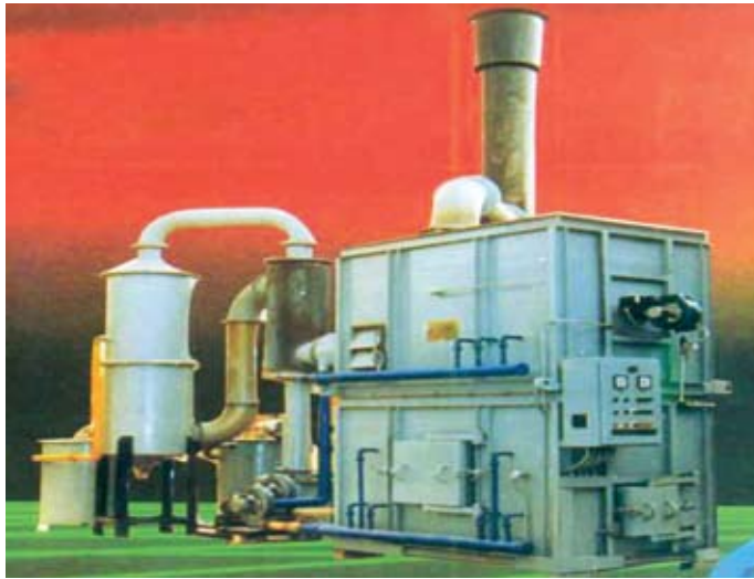
الصورة ( ١٣- ١ ) المحرقة التى يتم إنتاجها بواسطة الإنتاج الحربى مزودة بوحدة تنقية الغازات المتصاعدة التى تعمل بالنظام الرطب
