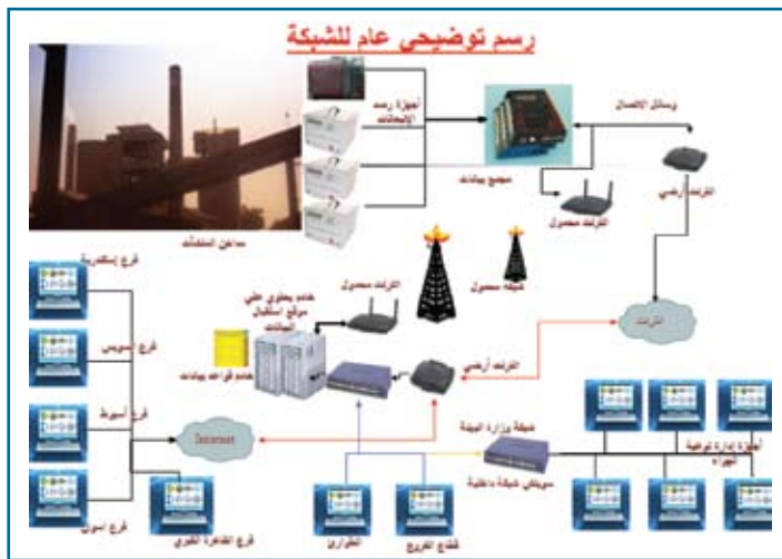
صورة (٦-١) الشكل العام لشبكة رصد الانبعاثات الصناعية بعد التطوير
