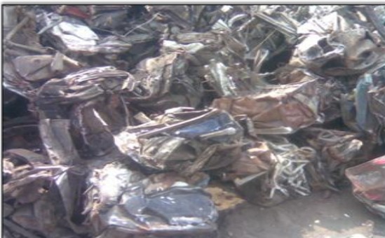
صورة (٨-١) مرحلة كبس التاكسيات القديمة بالمصنع
