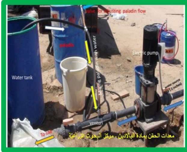
صورة (٣-٥) طريقة معاملة التربة بمادتي الأجروسيلون والبالادين وفاعلية البدائل
